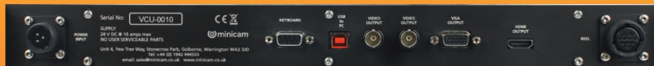
Le panneau arrière comporte des connecteurs pour les moniteurs HDMI et VGA. Les sorties vidéo composites BNC, un port USB permettant la connexion à un PC pour des fonctions de contrôle externes, et une connexion pour le clavier de bureau VKU500 assorti.
