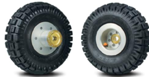
Pour les conduites fortement envasées, nous recommandons les roues de 250 mm (QRW250/150), qui sont également nécessaires pour centraliser le chariot dans les conduites de 1000 mm de diamètre.
