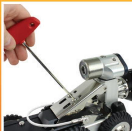
Pantographe manuel réglage rapide
